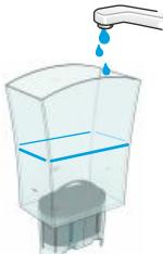
Schuif het waterreservoir heen en weer om luchtbelletjes uit de filter te verwijderen.
