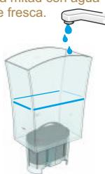
Schud het waterreservoir heen en weer om luchtbellen uit de filter te verwijderen.
